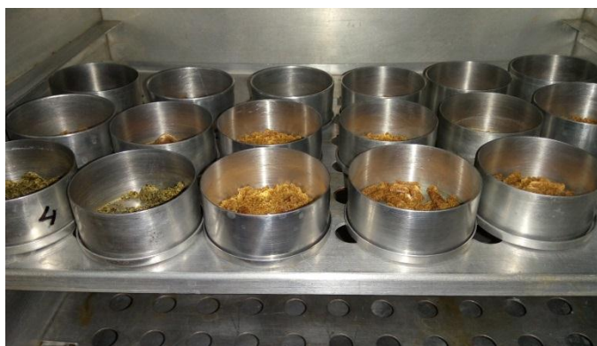
Slika 20 Sušenje uzoraka sjemenki i pogače u sušioniku
