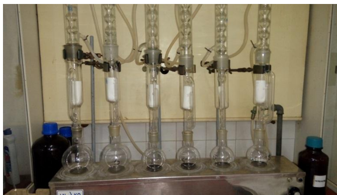
Slika 21 Ekstrakcija ulja aparaturom po Soxhletu
