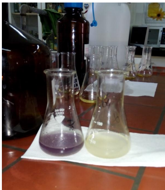
Slika 23 Promjena boje tijekom određivanja Pbr-a u ulju
