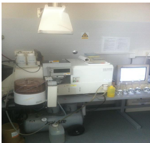
Slika 4 AAS spektrometar, plamena tehnika
