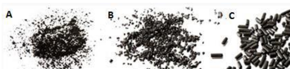
Slika 5. Vrste aktivnog ugljena: A-prah, B-granulirani, C- ekstrudirani (Bansal i Goyal, 2005.)
