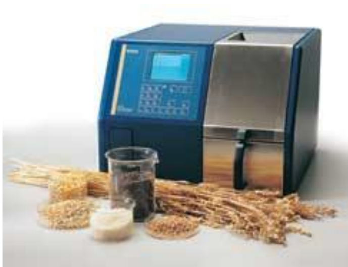
Slika 4 Uređaj „Infratec“ za određivanje udjela proteina
