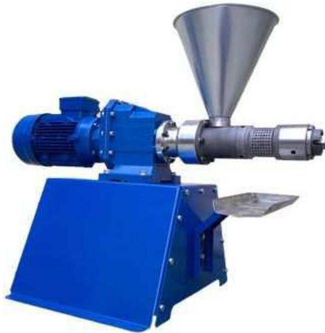
Slika 3. Laboratorijska kontinuirana pužna preša, proizvođač ElektroMotor – Šimon d. o. o.
