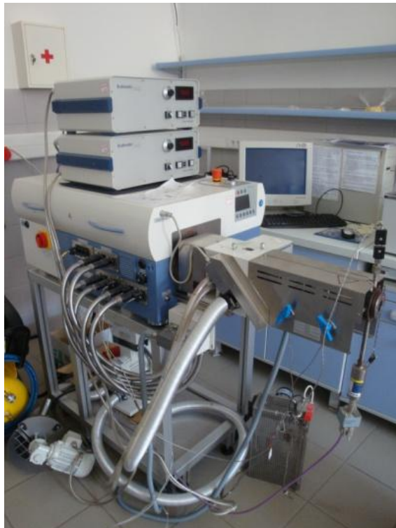
Slika 5 Laboratorijski jednopužni ekstruder Brabender 19/20DN (Jozinović, 2015)
