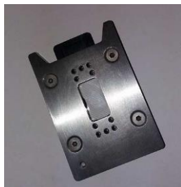
Slika 5 Čip (element mikroreaktora ugrađen u kućište)
