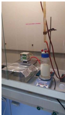
Slika 6 Sinteza biodizela u kotlastom reaktoru
