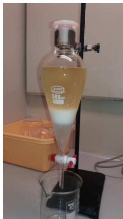
Slika 7 Separacija biodizela od ostalih komponenti reakcijske smjese (glicerol, voda, lipaza, metanol) nakon transesterifikacije
