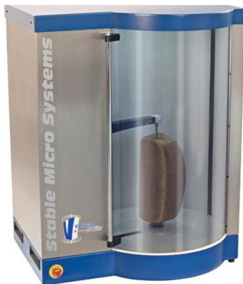
Slika 4 Volscan Profiler, uređaj za mjerenje volumena
