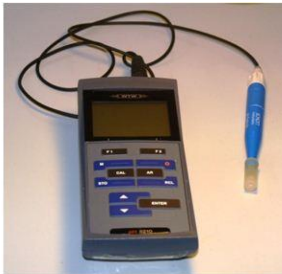
Slika 18 Prijenosni pH metar pH 3210/3310 tvrtke WTW
