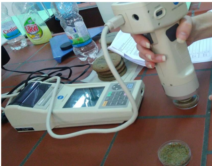
Slika 2 Određivanje boje kolorimetrom u usitnjenom čajnom pecivu
