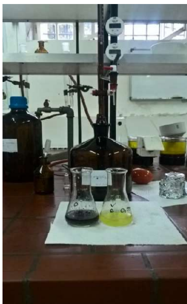
Slika 12 Titracija s \text{Na}_2\text{S}_2\text{O}_3
