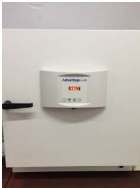
Slika 16. Termostat (sušionik) zagrijan na 98 °C (Izvor: autor)
