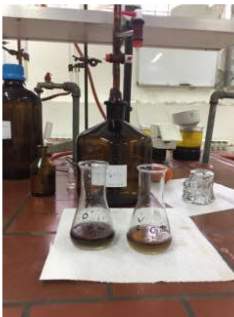
Slika 13. Titracija ulja s \text{Na}_2\text{S}_2\text{O}_3 (Izvor: autor)
