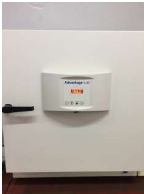
Slika 16. Termostat (sušionik) zagrijan na 98 °C (Izvor: autor)
