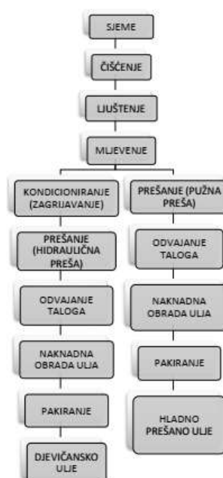
Slika 2. Blok shema proizvodnje jestivih nerafiniranih ulja iz uljarica (Dimić i sur., 2002.)
