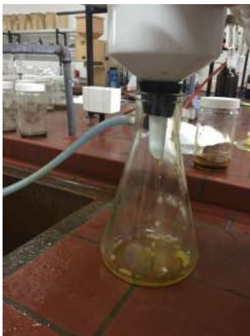
Slika 6. Vakuum filtracija sirovog ulja (Izvor: autor)
