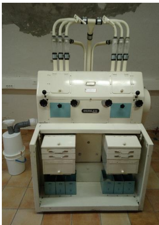
Slika 7 Bühler-ov MLU-202 laboratorijski mlin (vlastiti izvor)
