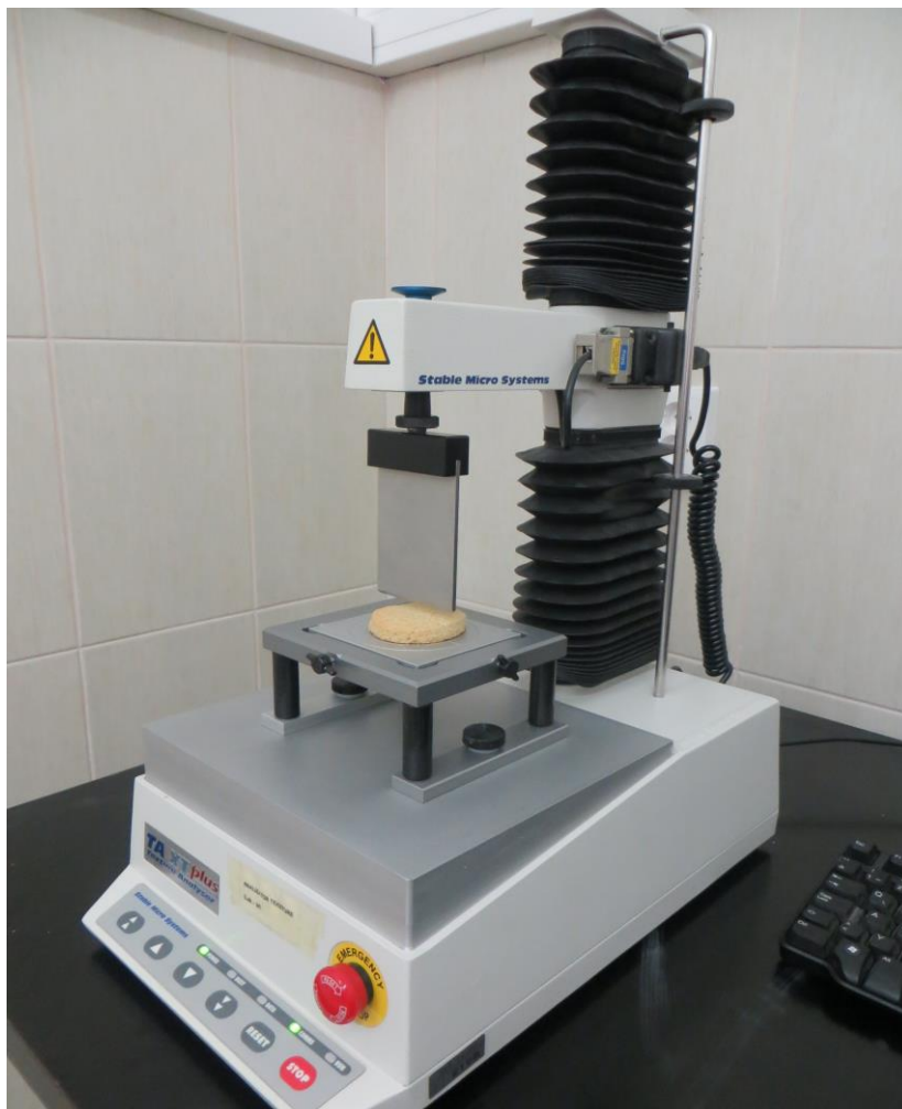
Slika 2. Analizator teksture TA.XT Plus s opremom za savijanje/lomljenje uzoraka
