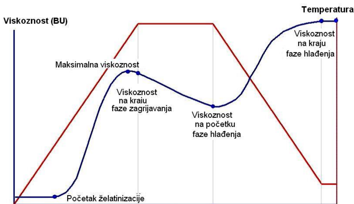
Slika 10 Krivulja promjene viskoznosti tijekom želatinizacije suspenzije škroba, mjerene pomoću Brabender-ovog Viskoamilografa (Ačkar, 2010)
