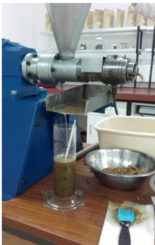
Slika 7 Mjerenje volumena i temperature sirovog ulja
