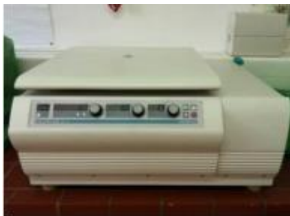
Slika 3.6. Multifuge 3 L-R centrifuga s hlađenjem
