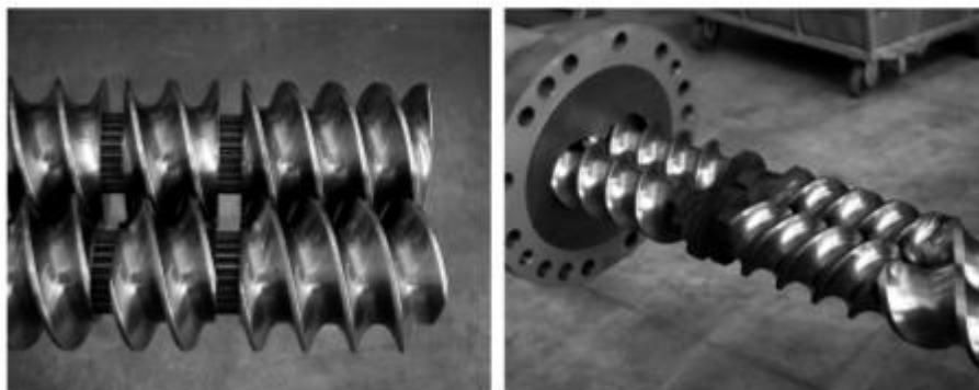
Slika 4 Modularna konstrukcija puževa kod dvopužnih ekstrudera (Móscicki, 2011)
