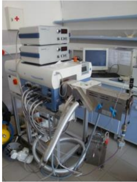
Slika 11 Laboratorijski jednopoluzni ekstruder Brabender 19/20 DN
