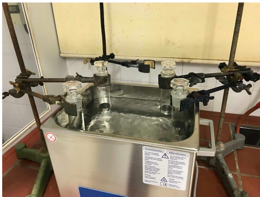
Slika 4 Ekstrakcija eutektičkim otapalima u ultrazvučnoj kupelji
