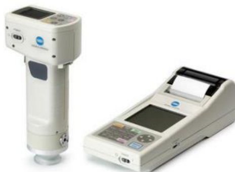
Slika 14 Kromametar Konica Minolta CR-400 (Jozinović, 2015.)
