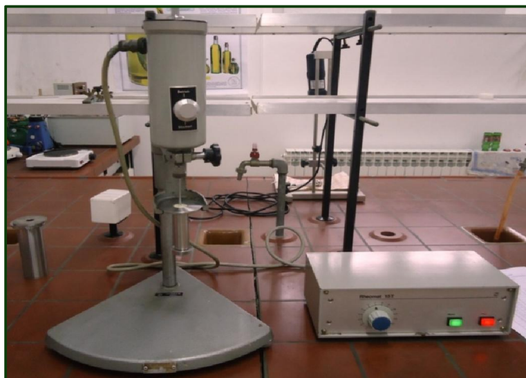
Slika 17 Rotacijski viskozimetar s koncentričnim cilindrima, model Rheomat 15T
