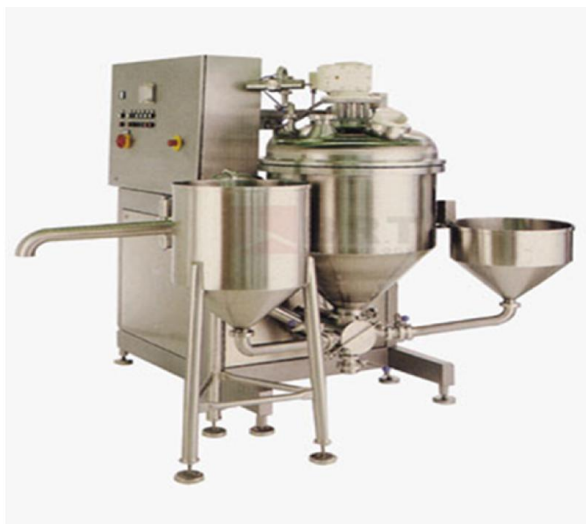
Slika 2 Poluautomatski uređaj za proizvodnju majoneze kapaciteta 100 kg
