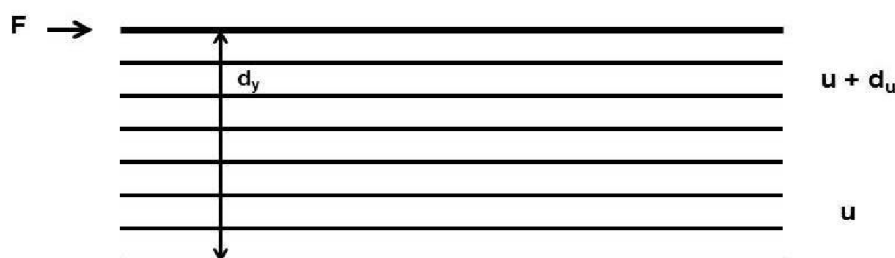
Slika 6 Prikaz viskoznog ponašanja tekućine (Lovrić, 2003.)
