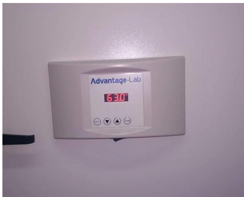
Slika 20 Ventilacijski sušionik s konstantnom temperaturom 63 °C
