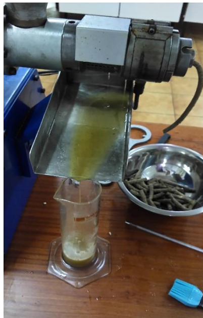
Slika 9 Mjerenje volumena i temperature sirovog ulja
