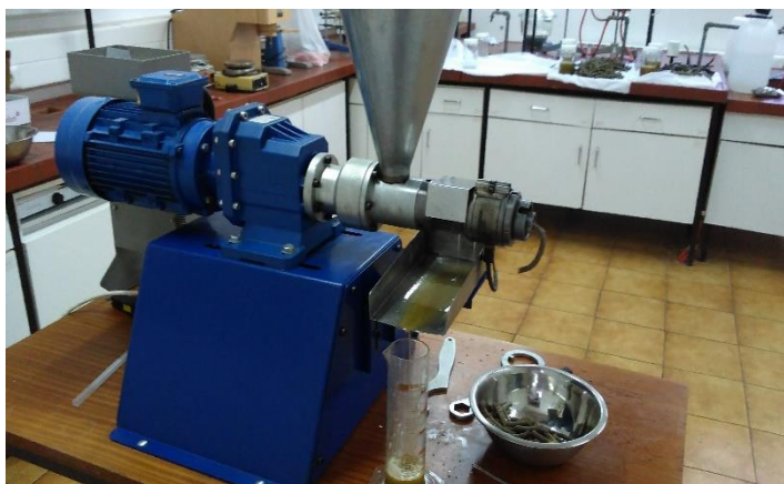
Slika 7 Proizvodnja sirovog ulja i izlaz pogače na kontinuiranoj pužnoj preši
