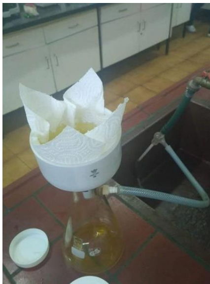
Slika 10 Vakum filtracija sirovog ulja preko Büchner-ovog lijevka
