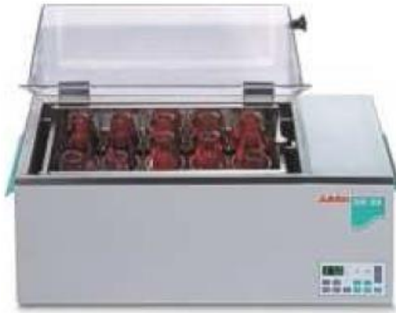
Slika 10 Vodena kupelj s trešnjom JULABO SW-23
