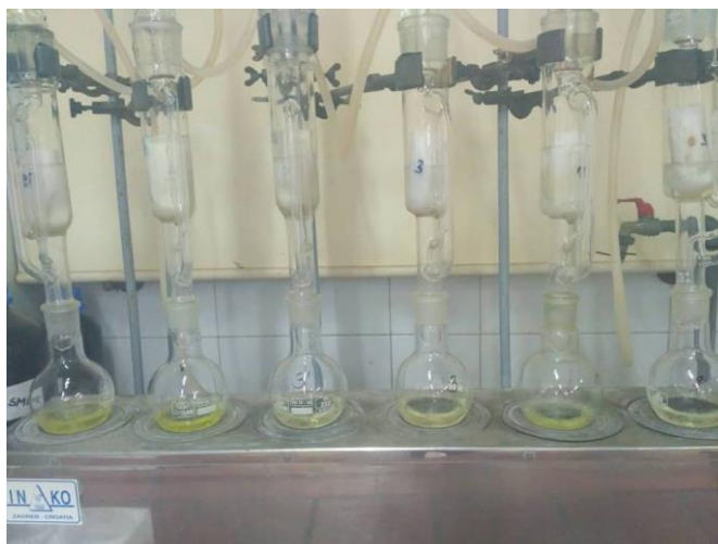
Slika 13 Ekstrakcija ulja po Soxhlet-u
