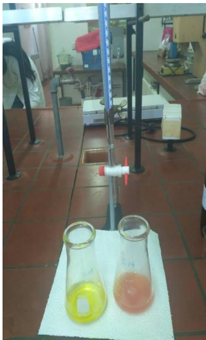
Slika 14 Titracija ulja s NaOH
