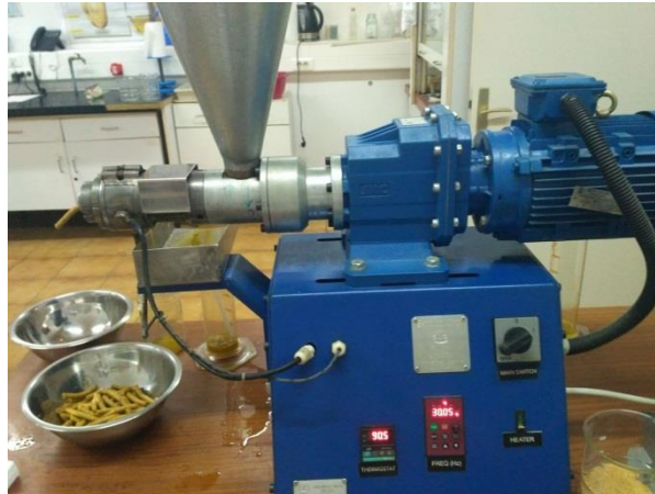
Slika 10 Proizvodnja sirovog ulja i izlaz pogače na kontinuiranoj pužnoj preši
