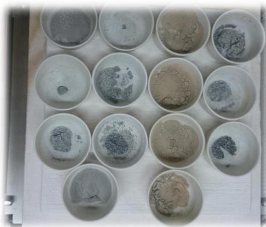
Slika 31 Hlađenje uzoraka na termorezistentnoj ploči nakon spaljivanja
