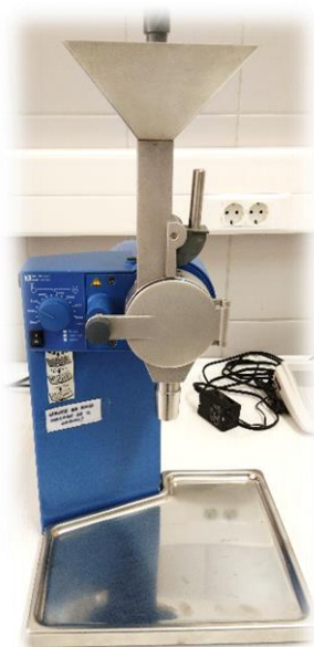
Slika 23 Laboratorijski mlin IKA MF10 (Staufen, Njemačka)
