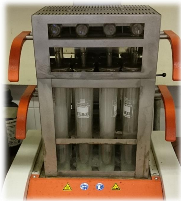
Slika 33 Blok za digestiju s uzorcima nakon spaljivanja
