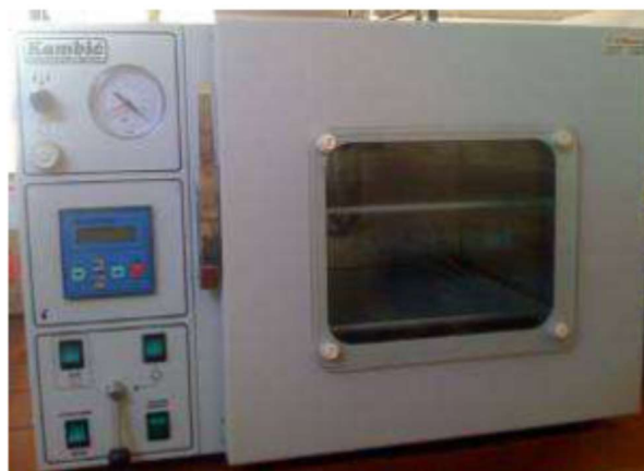
Slika 24 Vakuum sušionik (Kambič VS 50S, Slovenija).
