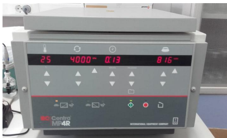
Slika 15 Centrifuga IEC Centra-MP4R
