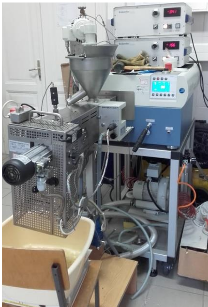
Slika 11 Jednopolžni laboratorijski ekstruder 19/20 DN, Brabender GmbH
