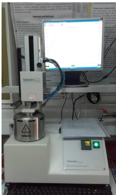
Slika 17 Brabenderov mikro visko-amilograf
