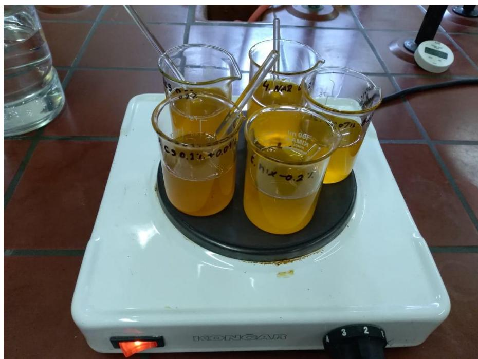
Slika 10 Priprema uzorka ulja s dodatkom antioksidanasa
