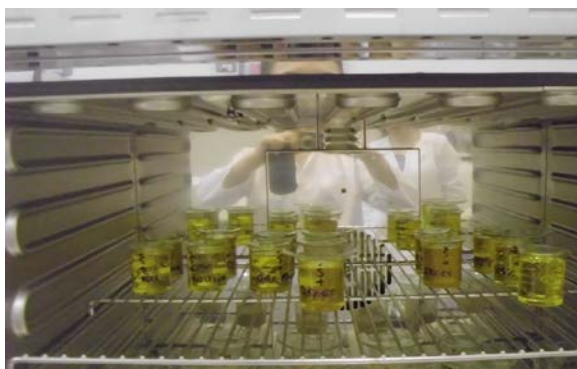
Slika 8 Uzorci ulja šafranike u sušioniku Memmert
