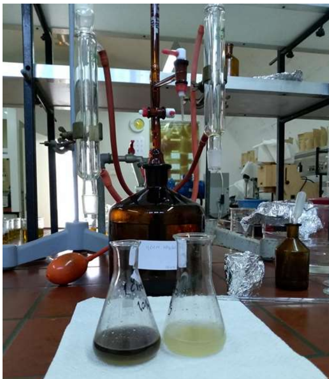
Slika 7 Određivanje peroksidnog broja u uzorcima mješavine ulja
