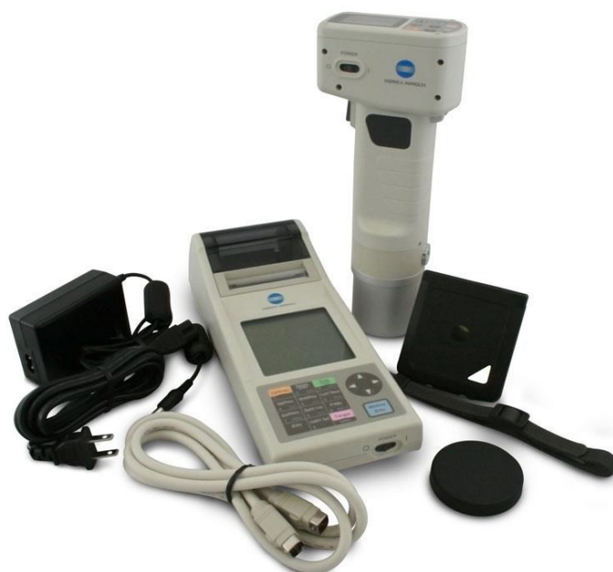
Slika 8. Kolorimetar Konica Minolta CR-400 (Web 8)
