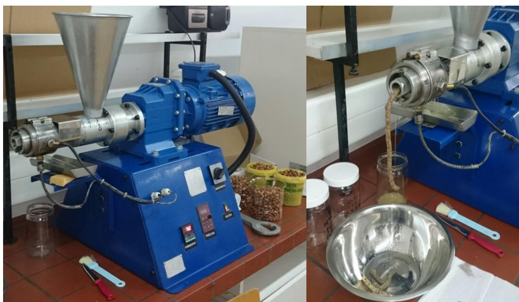
Slika 13 Postupak hladnog prešanja jezgre lješnjaka i proizvodnja ulja
