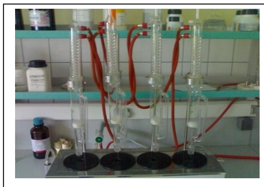
Slika 10 Aparatura za ekstrakciju masti po Soxhletu (Jozinović, 2011.)
