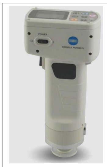
Slika 7 Kromametar Konica Minolta CR-300 (Tanasković, 2014.)
