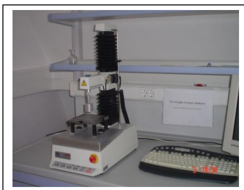
Slika 6 TA.XT2 Plus Texture Analyser (Tanasković, 2014.)
