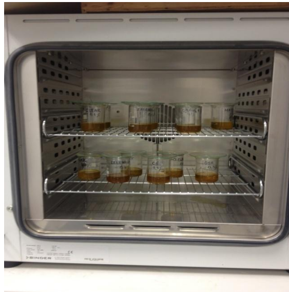
Slika 17 Termostat sa uzorcima ispitivanih ulja
