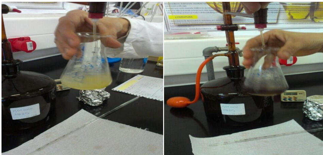
Slika 13 Promjena boje prilikom titracije određivanja peroksidnog broja
