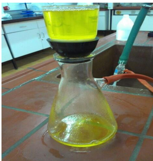
Slika 14 Postupak filtriranja ulja
