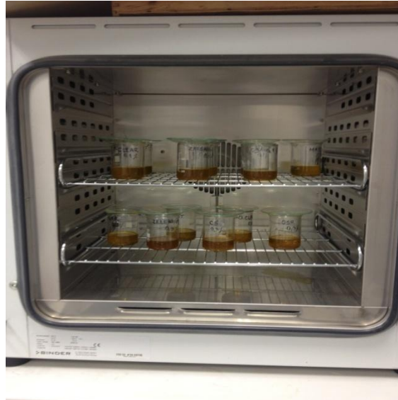
Slika 17 Termostat sa uzorcima ispitivanih ulja
