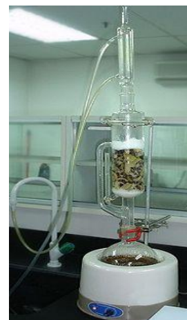
C) Ekstrakcija po Soxhletu (Tomas i sur., 2013)
