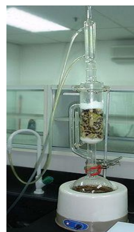
C) Ekstrakcija po Soxhletu (Tomas i sur., 2013)
