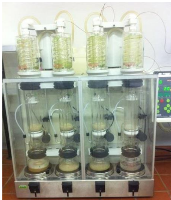
B) Univerzalni sustav za ekstrakciju (Büchi, B-811 LSV)
