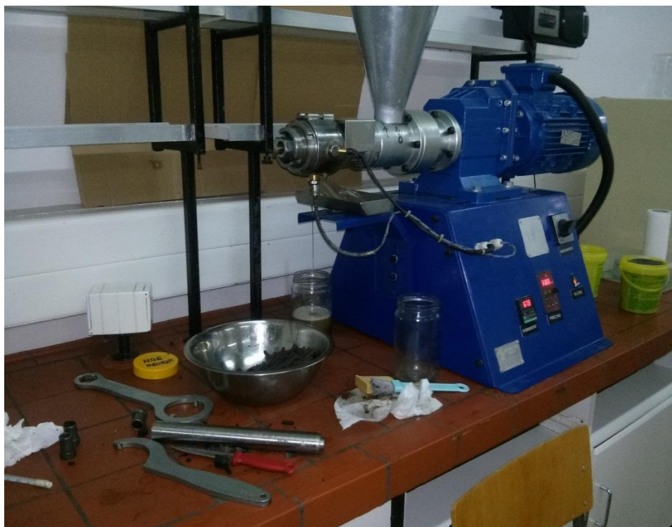
Slika 5 Laboratorijska kontinuirana pužna preša
