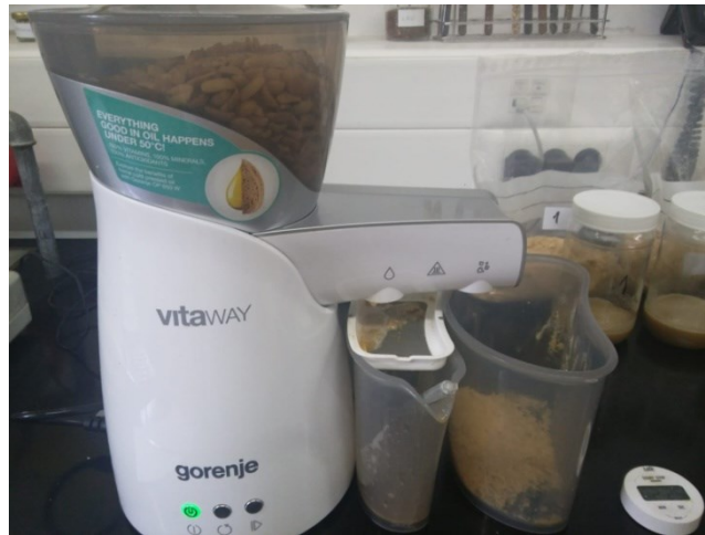
Slika 9 Laboratorijska pužna preša (OP-650W)
