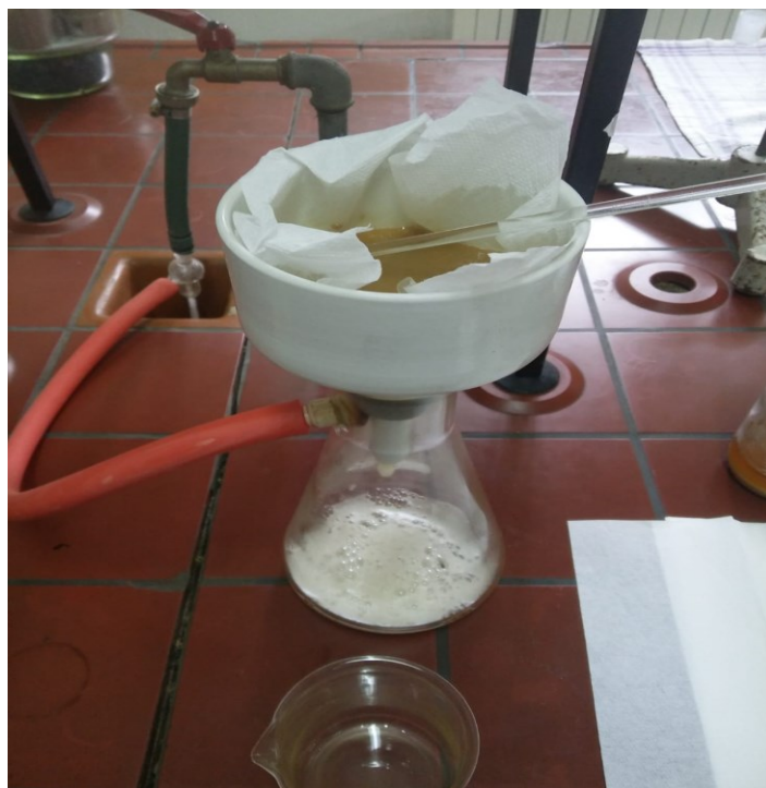
Slika 12 Vakuum filtracija sirovog ulja preko Büchner-ovog lijevka
