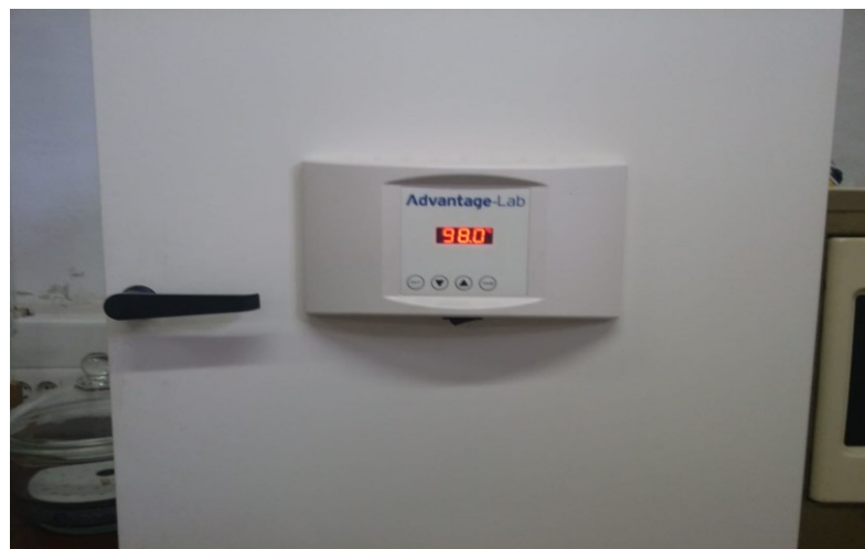
Slika 17 Sušionik zagrijan na temperaturu 98°C
