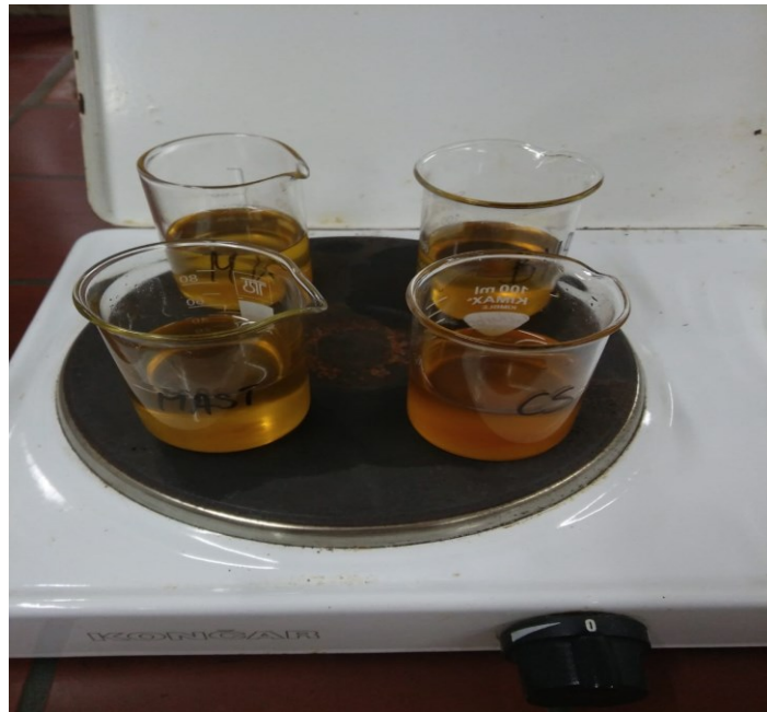
Slika 16 Priprema uzorka za ispitivanje oksidacijske stabilnosti testom održivosti na 98°C
