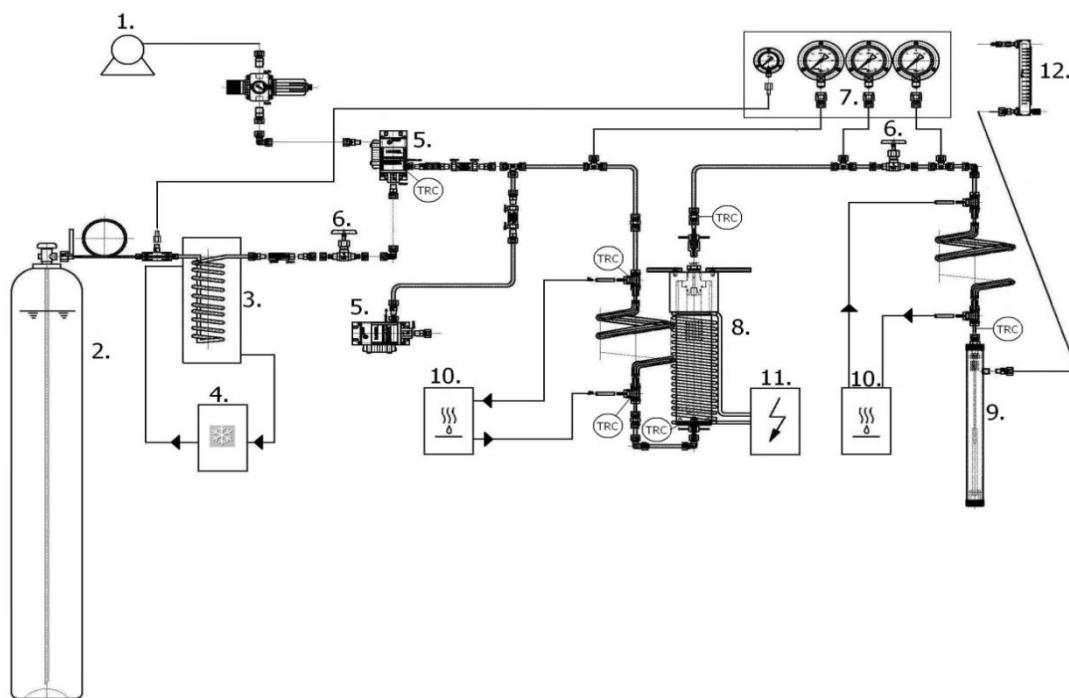
**Slika 7** Procesna shema uređaja za ekstrakciju superkritičnim CO<sub>2</sub>
