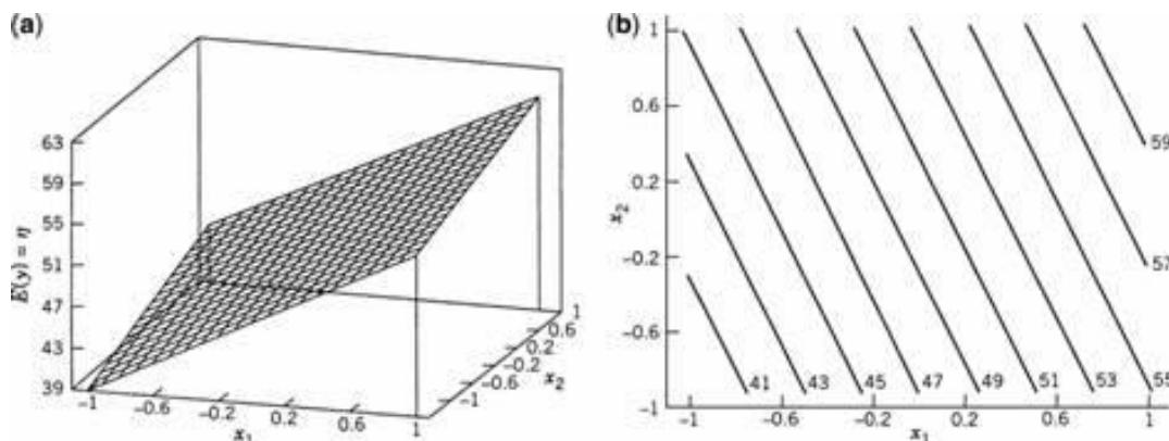
**Slika 4 (a)** Primjer odzivne površine za modele prvog reda (3D); **(b)** Primjer odzivne površine prikazane konturnim dijagramom za modele prvog reda (2D) (Myers i sur., 2009)
