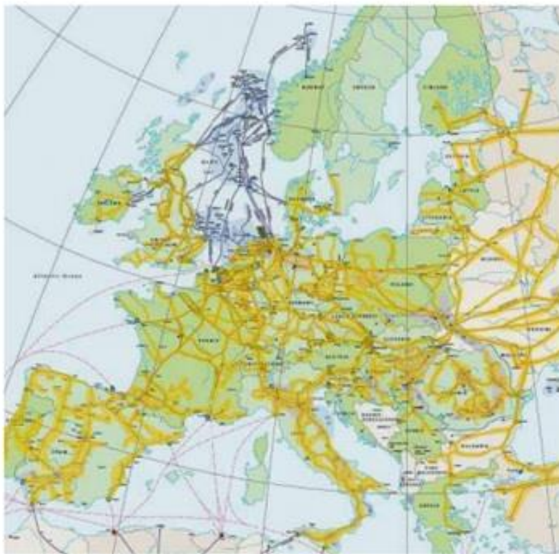
Slika 1 Potencijalna europska mreža cjevovoda za bioplin (Al Seadi i sur., 2008)
