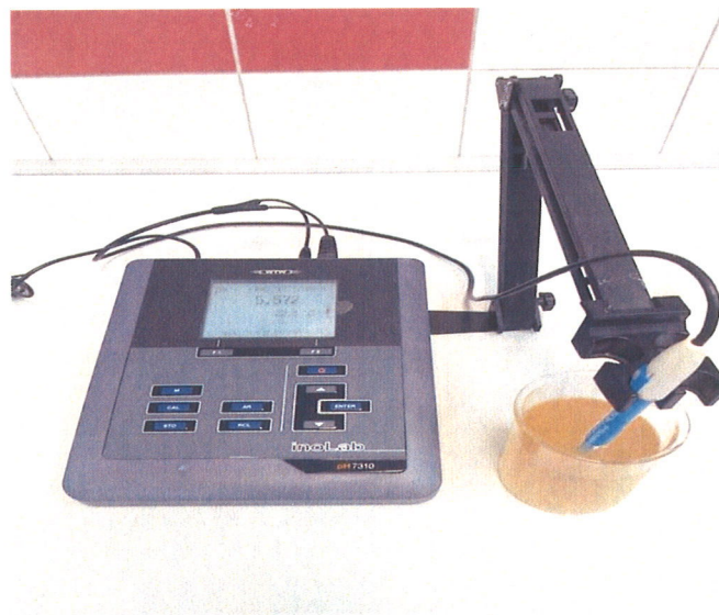
Slika 18. Uređaj za mjerenje pH sladovine
