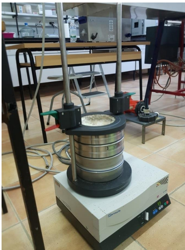
Slika 7 Uređaju za trešnju sita Retsch AS 200
