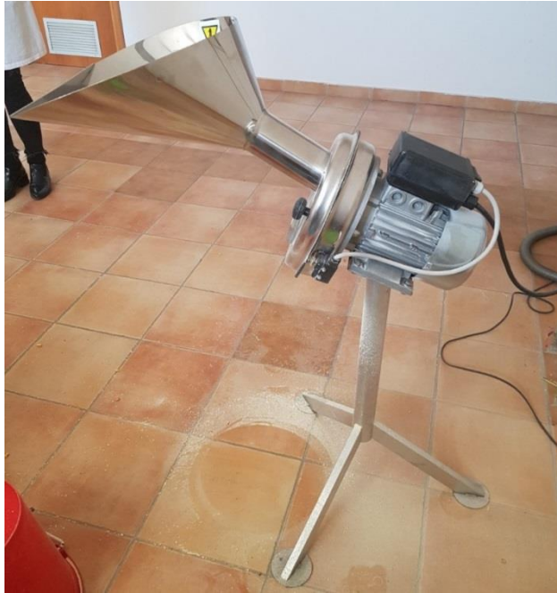
Slika 5 Mlin – Molino Trita Piante, E0585
