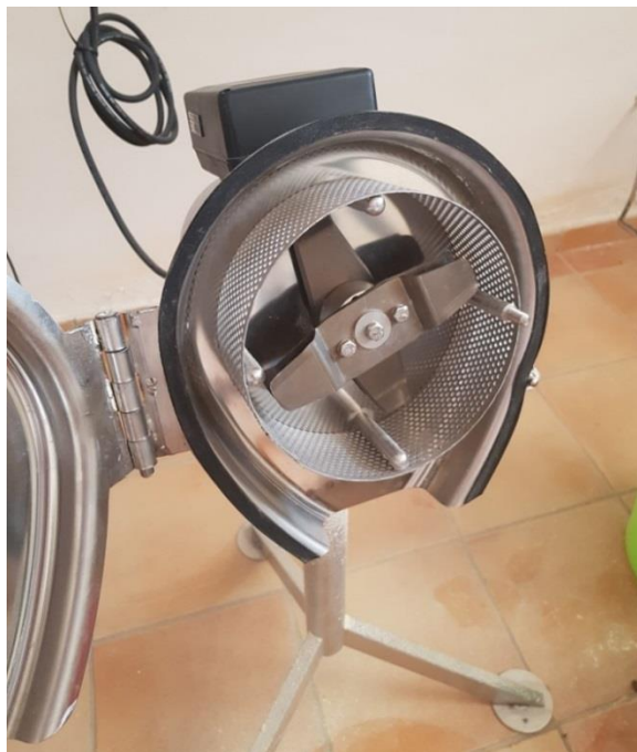
Slika 6 Sito mlina Molino Trita Piante, E0585 (3 mm)
