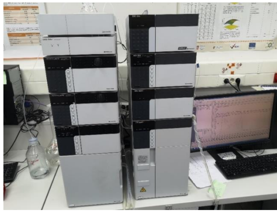
Slika 10 Kapljevinski kromatograf visokog učinka (HPLC)
