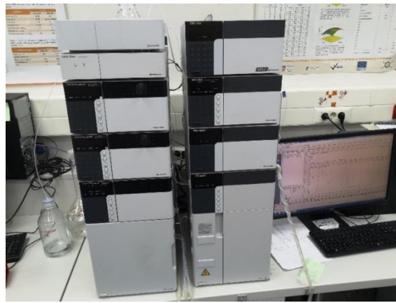
Slika 10 Kapljevinski kromatograf visokog učinka (HPLC)
