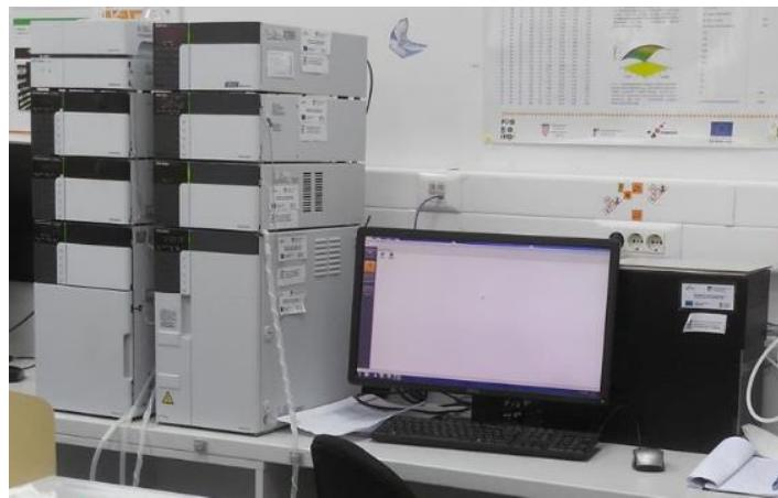
Slika 13. UHPLC spojen na računalo
