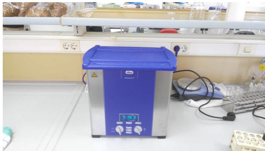
Slika 11. Ultrazvučna kupelj
