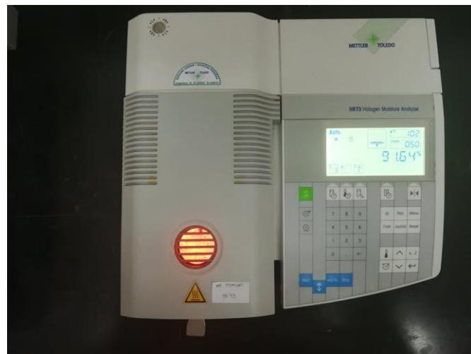
Slika 10. Uređaj za radijacijsko-infracrveno sušenje HR-73, Mettler Toledo
