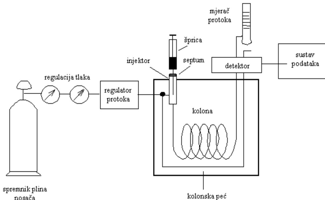
**Slika 6** Shematski prikaz plinskog kromatografa (Deur-Šiftar, 1973.)
